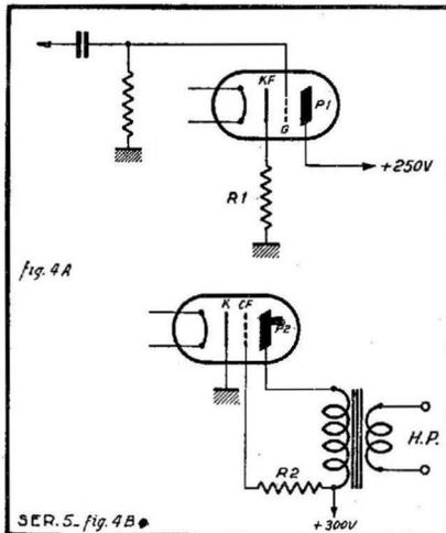
La sensibilité est due à la pente élevée et à la charge anodique importante du second élément. La fidélité provient de ce que l'élément de puissance est une triode.
