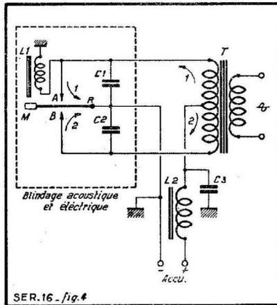
étant court-circuitée, la masselotte M n'est plus attirée, et la lame tend à reprendre sa position d'équilibre. Par son élasticité, elle dépasse cette position et ferme le contact B. Le courant s'inverse dans le transformateur et suit les flèches 2. Le contact A est ouvert, la bobine L1
