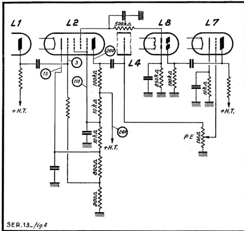
à un faible potentiel positif par rapport à la masse et fortement négative par rapport à la cathode qui est à +13 volts. L'amplification totale de l'amplificateur est minimum. Pendant un fortissimo, la tension prélevée en L4 est importante ainsi que la tension redressée. La polarisation de G3 (tube L2) est fortement positive par rapport à la masse et presque au même potentiel que la cathode. La pente du tube augmente et l'amplification est maximum.
