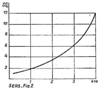
Sensibilité = 0,15 volt sur la prise pick-up donne 3 watts et 0,25 watts donne 4 watts.
